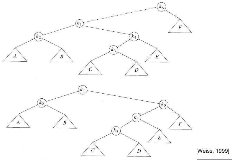
Durch die Rotationen wird der Knoten nach dem Zugriff bis an die Wurzel transportiert.
