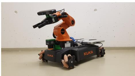
**Abbildung 14:** Kuka YouBot mit Mecanum-Rädern und 5 DoF-Greifarm. Sensorik besteht aus einem 270-Grad-Laser und einem RGB-Tiefen-Sensor.
