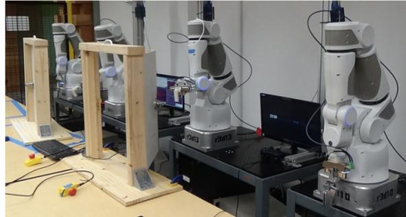
**Abbildung 2:** Zwei 7-DoF-Greifarmroboter, die ein Türöffnungsvorgang mit einer DQN-Variante lernen (GHLL17). Die Roboter kennen ihre Endeffektor-Pose und die Pose des Handknaufs.
