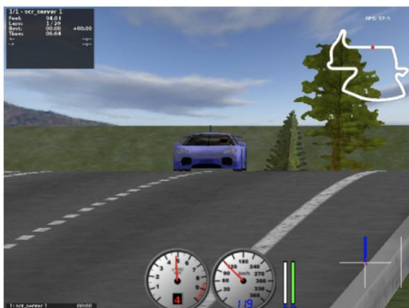
**Abbildung 4:** Simuliertes Fahrzeug, das mit dem DRL-Verfahren *Deep Deterministic Policy Gradient* (DDPG) die Verfolgung einer Fahrspur lernt (HLZ<sup>+</sup>21). Zu den Umgebungsinformationen des Fahrzeugs gehören die Längsgeschwindigkeit, die Quergeschwindigkeit, der Winkel zwischen der Fahrzeugrichtung und der Fahrbahn und der Abstand zur Mittellinie und zum Fahrbahnrand.
