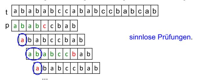
Der Algorithmus von Knuth-Morris-Pratt analysiert das Muster in einer Vorlaufphase und speichert Informationen über seine Struktur ab. Damit wird versucht, das Muster um mehr als ein Zeichen nach rechts zu verschieben. Sinnlose Prüfungen werden vermieden.
