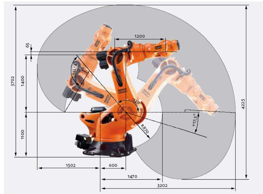
Kuka KR 1000 titan mit Arbeitsraum; [www.kuka.com](http://www.kuka.com)
